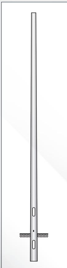
*Palo conico dritto da lamiera saldata spessore 3 mm, realizzato in acciaio S235 UNI EN 10219, zincato a caldo secondo UNI EN ISO 1461*
